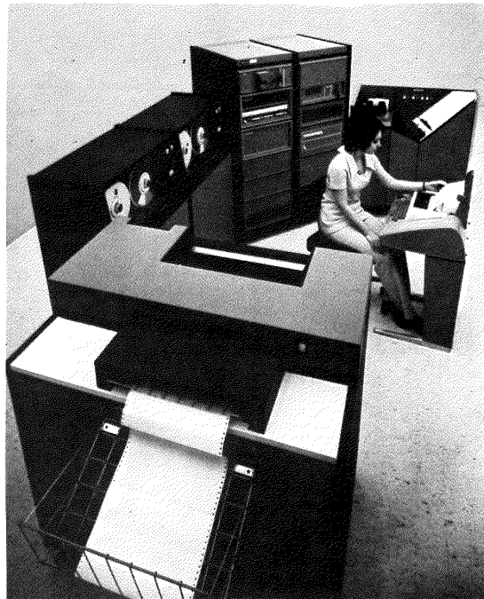
un sistema Honeywell 700 in configurazione comprendente, oltre all'unità centrale con lettore e perforatore di banda e governi linee, due unità a nastri magnetici, una stampante, un lettore di schede, e la telescrivente di console.
